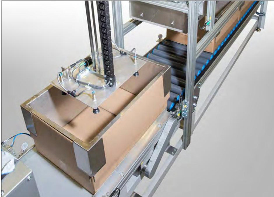
Boxenwechselband mit Zwischenlagenübersetzer.
