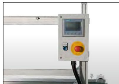
Bedienpanel mit HMI.
